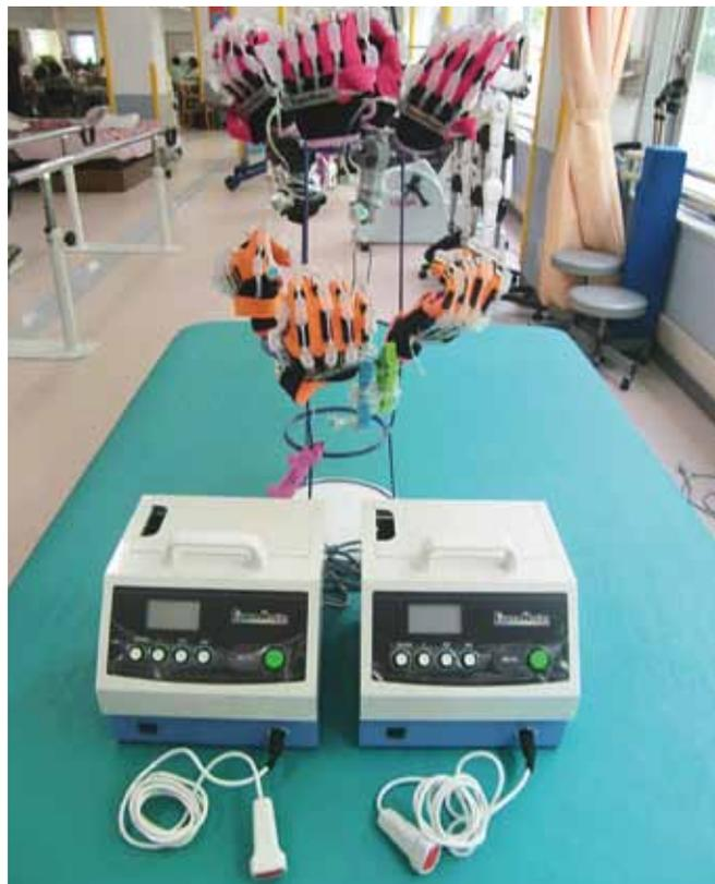
脳血管疾患により手や指が麻痺して拘縮してしまわれた方のQOL（生活の質）向上のため、空気圧を利用して、手を握ったり開いたりする動作を安全にサポートする装置です。
